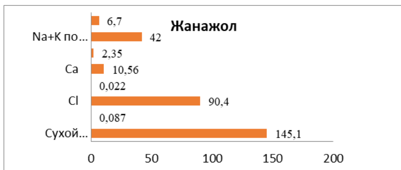
Рисунок 2. Сточные нефтепромысловые воды, их химический состав (г/л)
